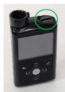
A tampa da pilha pode ser encontrada na parte superior da bomba onde se encontra o compartimento da pilha AA
